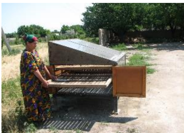
Рисунок 3. Сушилка абрикоса типа «горячий ящик» (по проекту MEDA). Вид сбоку и спереди.
