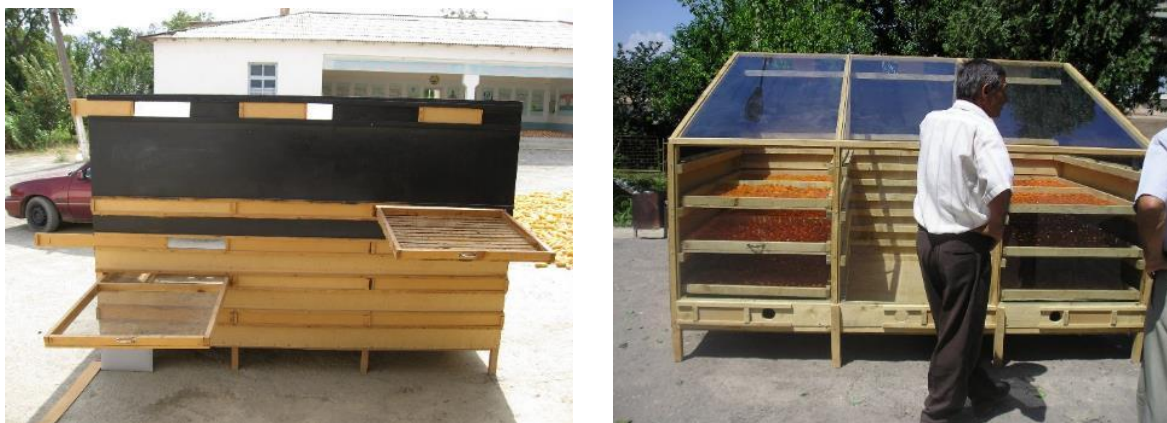
Рис 4. Солнечная камерная сушилка абрикоса по проекту Тошматова Б. Успешно прошедшая производственное испытание в 2008 - 2009г.
