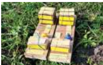
Фото №11. Определение степени покрытия с помощью водочувствительной бумаги: брусок 1 - качество покрытия рабочим раствором после калибровки опрыскивателя. Брусок 2 - качество покрытия рабочим раствором до калибровки опрыскивателя.
