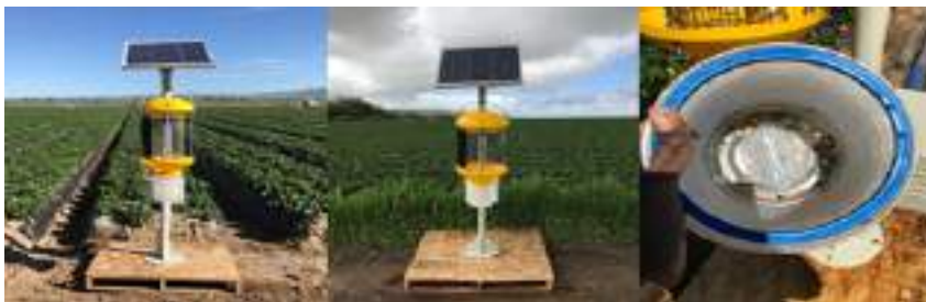
Фото №6. Ловушки УФ - излучения на солнечных батареях на обычных (слева) и органических (в центре) полях и насекомых, собранных в контейнере (справа)
